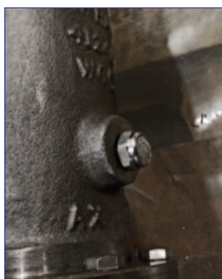
Filtro antipolvere su sfiato attuatore Bug screen on actuator vent
